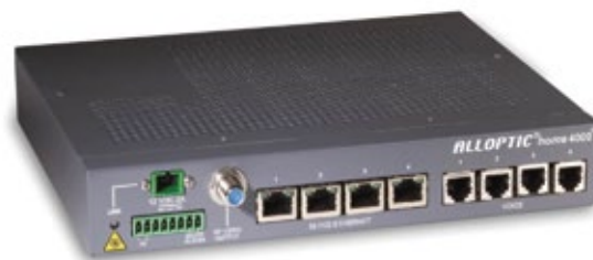
Equipamento ONT utilizado em condomínio na Bahia possui 4 portas de voz, 4 portas de dados, uma porta de TV e 8 portas para automação
