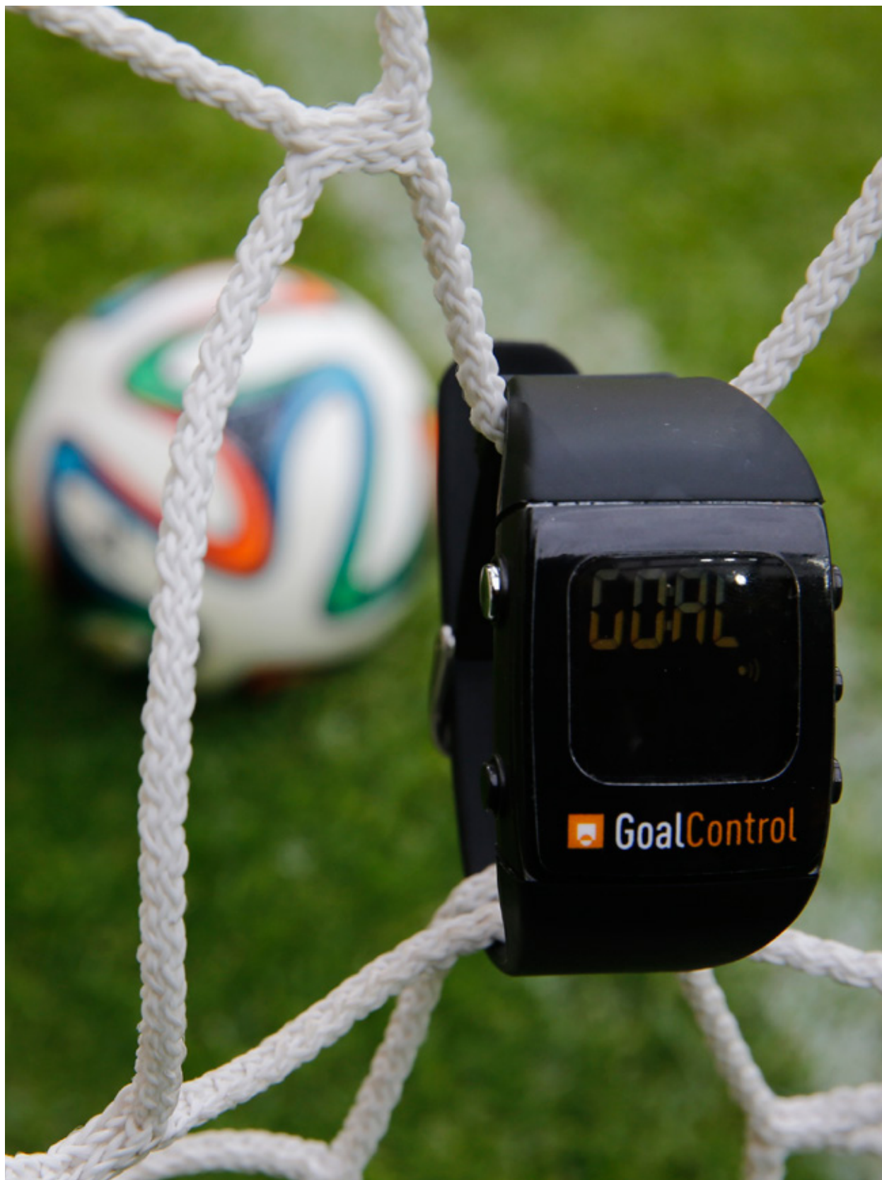
GoalControl: Nova tecnologia adotada pela Fifa para a Copa do Mundo no Brasil, tem como destaque o relógio inteligente que fica no pulso do juiz da partida. Assim que a bola ultrapassa a linha do gol, um sinal criptografado é enviado para o relógio do juiz e um aviso é mostrado. Segundo o site da empresa, o GoalControl-4D usa câmeras de alta velocidade e foi especialmente projetado para funcionar em quaisquer circunstâncias
