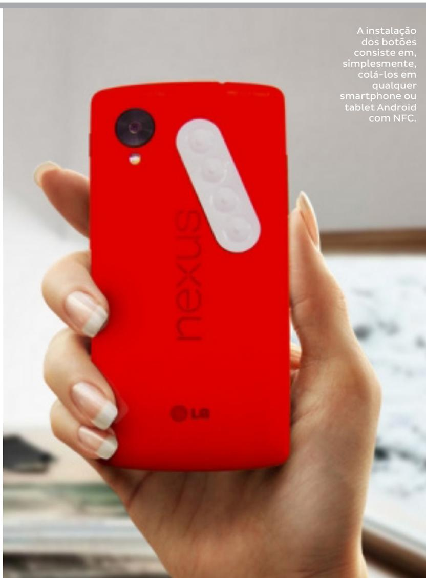
A instalação dos botões consiste em, simplesmente, colá-los em qualquer smartphone ou tablet Android com NFC.
