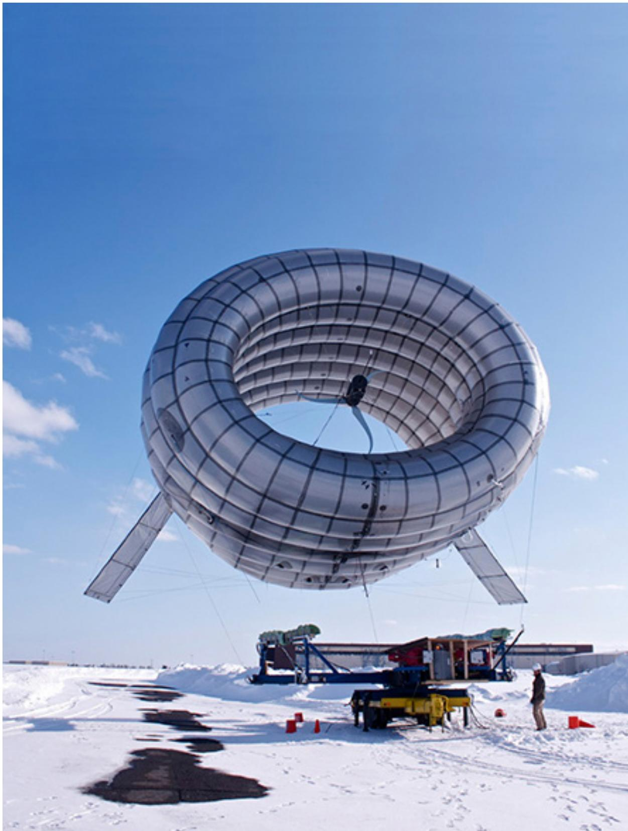
Turbina aérea flutuante (ou BAT: Buoyant Air Turbine) é um novo conceito que usa um invólucro cheio de hélio que possui uma concha inflável circular de 35 metros de diâmetro, feita do mesmo tecido resistente usado em dirigíveis e velas náutica para flutuar alto o suficiente para capturar os ventos mais fortes e produzir duas vezes mais energia.
